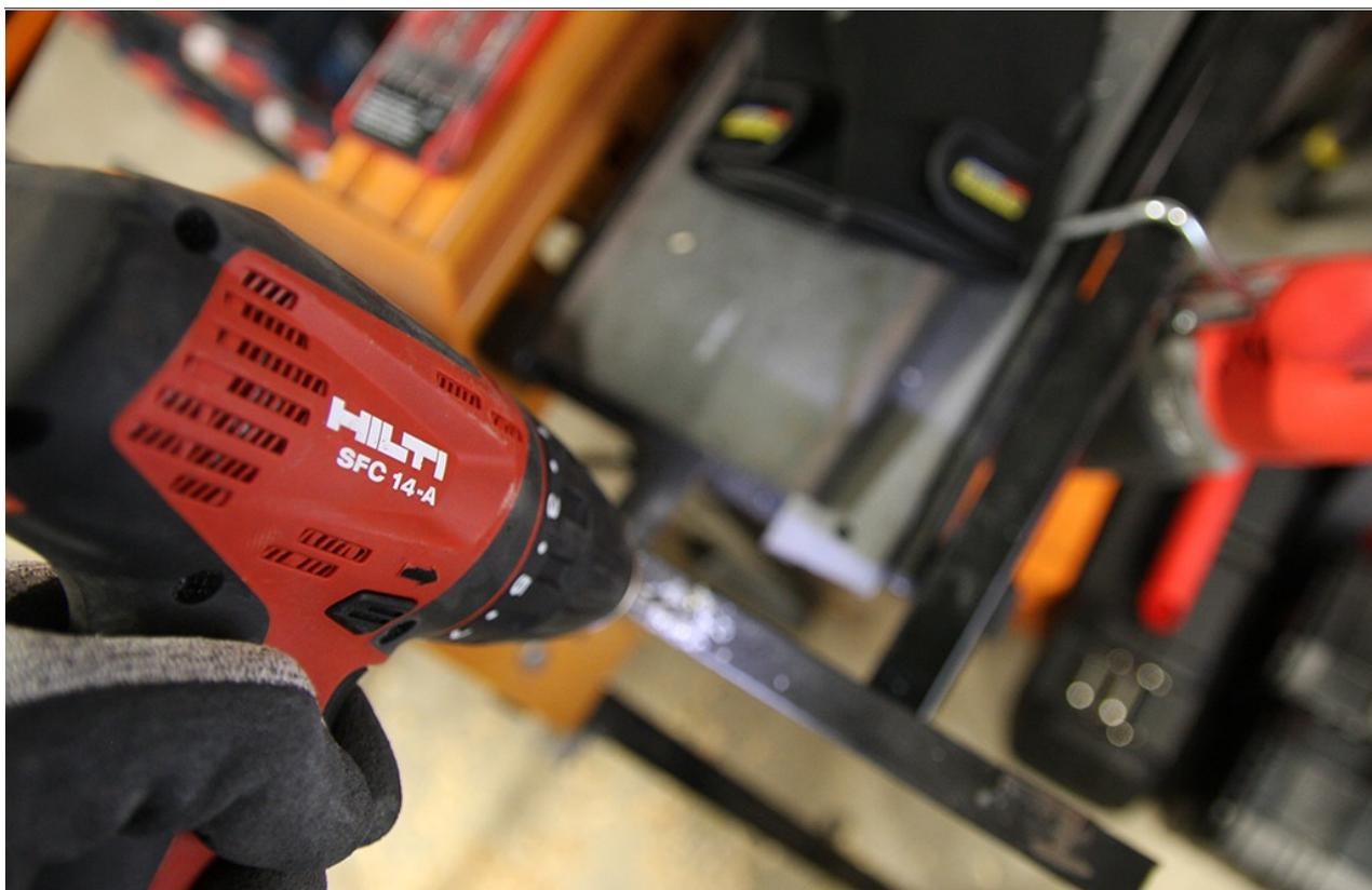
Avec un rapport poids/puissance élevé les perceuses-visseuses compactes sont appréciées par les agenceurs, cuisinistes et électriciens. Elles permettent de travailler dans les endroits difficiles d'accès avec un couple suffisant pour effectuer les travaux courants. Nous avons testé le modèle phare de la marque rouge et blanche la HILTI SFC 14-A.
